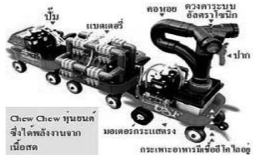
รูปที่ 6 แสดงหุ่นยนต์กินเนื้อที่ใช้หลักการเซลล์เชื้อเพลิงชีวภาพ ( ecurriculum.mv.ac.th/.../5.6/update/w157_01.htm )
