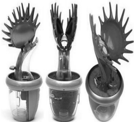
รูปที่ 5 แสดงหุ่นยนต์ดักแมลงโดยใช้หลักการของเซลล์เชื้อเพลิงชีวภาพ ( http://4.bp.blogspot.com/ )
